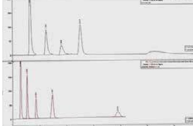
الشكل (5) A مخطط فصل يوضح فصل مزيج من (الكودئين، الكينين، الكلوروبروكائين والديفنهيدرامين) والمضاف إليه الفينول باستخدام عمود السيليس المطعم Nucleodur C18. الطور المتحرك (وقاء -70 أسيتونتريل 30) التدفق 1 مل بالدقيقة. درجة حرارة الفصل المستخدمة 25o.B نفس الشروط السابقة لكن درجة حرارة الفصل المستخدمة 130o.
