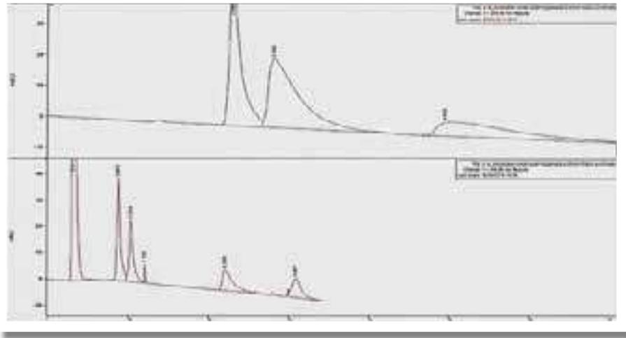
الشكل (4) A مخطط يوضح فصل مزيج من (الكودئين، الكينين، الكلوروبروكائين والديفنهدرامين) مضافا إليها الفينول باستخدام عمود كربون الغرافيت. درجة حرارة الفصل 30 درجة مئوية، الطور المتحرك (وقاء فوسفاتي -50أسيتونتريل 50). B درجة حرارة الفصل 150o , الطور المتحرك (وقاءفوسفاتي-50أسيتونتريل 50).
