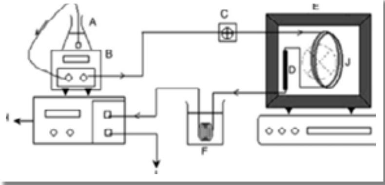
الشكل (1) السلسلة الكروماتوغرافية المستخدمة مع أجزائها [A] مخزن الطور المتحرك [B] المضخة الثنائية [C] الحقن الأوتوماتيكي [D] العمود [E] الفرن [F] نظام التبريد (حمام تليجي) [G] الكاشف [H] برنامج التحكم على الحاسوب [I] أنبوب الضغط العكسي [J] أنبوب تسخين الطور المتحرك.
