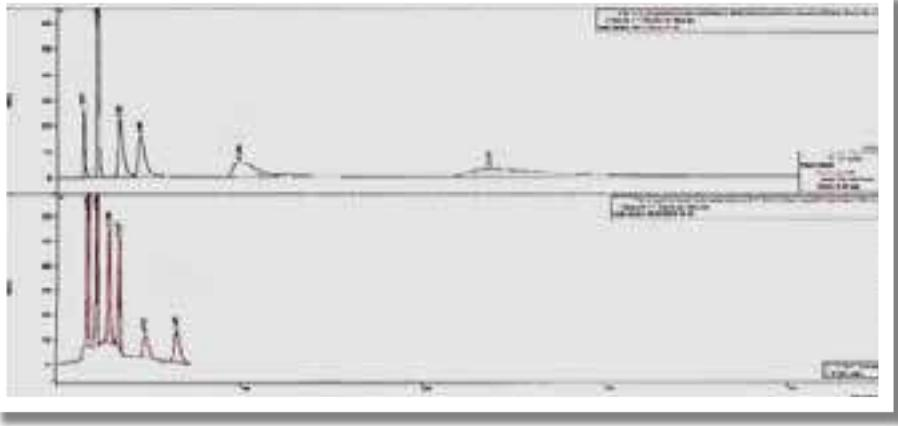
الشكل (3) A مخطط فصل يوضح فصل مزيج من (الكودئين، الكينين، الكلوروبروكائين والديفنهيدرامين) مضافا إليها الفينول واليوراسيل باستخدام عمود البولييمير، التدفق 1 مل بالدقيقة. درجة حرارة الفصل 50 درجة مئوية، الطور المتحرك (وقاء فوسفاتي -30أسيتونتريل 70). B درجة حرارة الفصل 150o، الطور المتحرك (وقاء فوسفاتي -50أسيتونتريل 50).
