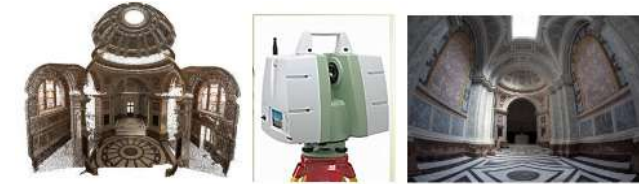
شكل (5): استخدام تقانات Laser Scanners في التوثيق الرقمي ثلاثي الأبعاد للمباني الأثرية.
