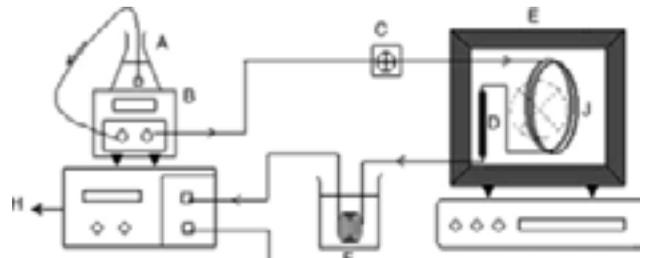
الشكل (1) السلسلة الكروماتوغرافية المستخدمة مع أجزائها [A] مخزن الطور المتحرك [B] المضخة الثنائية [C] الحاقن الأوتوماتيكي [D] العمود [E] الفرن [F] نظام التبريد (حمام ثلجي) [G] الكاشف [H] برنامج التحكم على الحاسوب [I] أنبوب الضغط العكسي [J] أنبوب تسخين الطور المتحرك.
