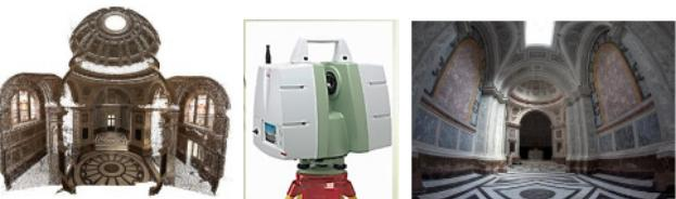
شكل (5): استخدام تقانات Laser Scanners في التوثيق الرقمي ثلاثي الأبعاد للمباني الأثرية.
